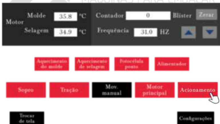
Imagem 24 — Tecla Acionamento na tela de operações
