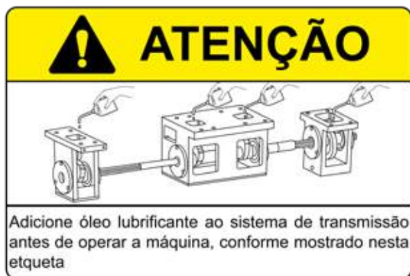
Imagem 8 — Lubrificação do sistema de transmissão
